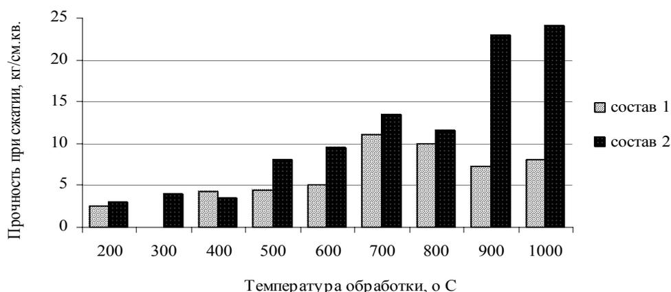
Рис. Зависимость прочности при сжатии от температуры обработки образцов. Состав мертеля, мас. %: 1 - шамот 70, глина 15, ФА 15; 2 - шамот 75, глина 15, ФА 10, NiO 3 сверх 100%.
