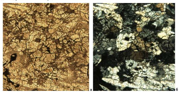
Рис. 2. Микроструктура стабилизированного шлака. Хорошо видны идиоморфные кристаллы шпинели I-ой генерации и скопления мелких зерен шпинели II-ой генерации. Свет проходящий, а - без анализатора, б – с включенным анализатором, ув.100
