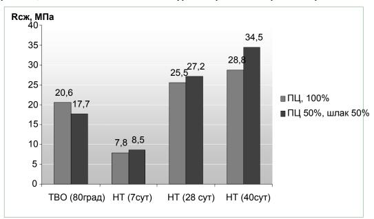
Рис. 3. Прочность при сжатии бетонов на портландцементе (ПЦ) и на молотом стабилизированном шлаке (шлак) после тепловлажностной обработки при  $80^{0}$ C (ТВО) и нормального твердения (НТ)
